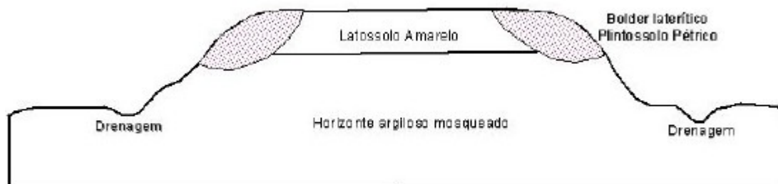
Figura 45: Bolder lateríticos sustentando as bordas da colina constituídas por Latossolo.
