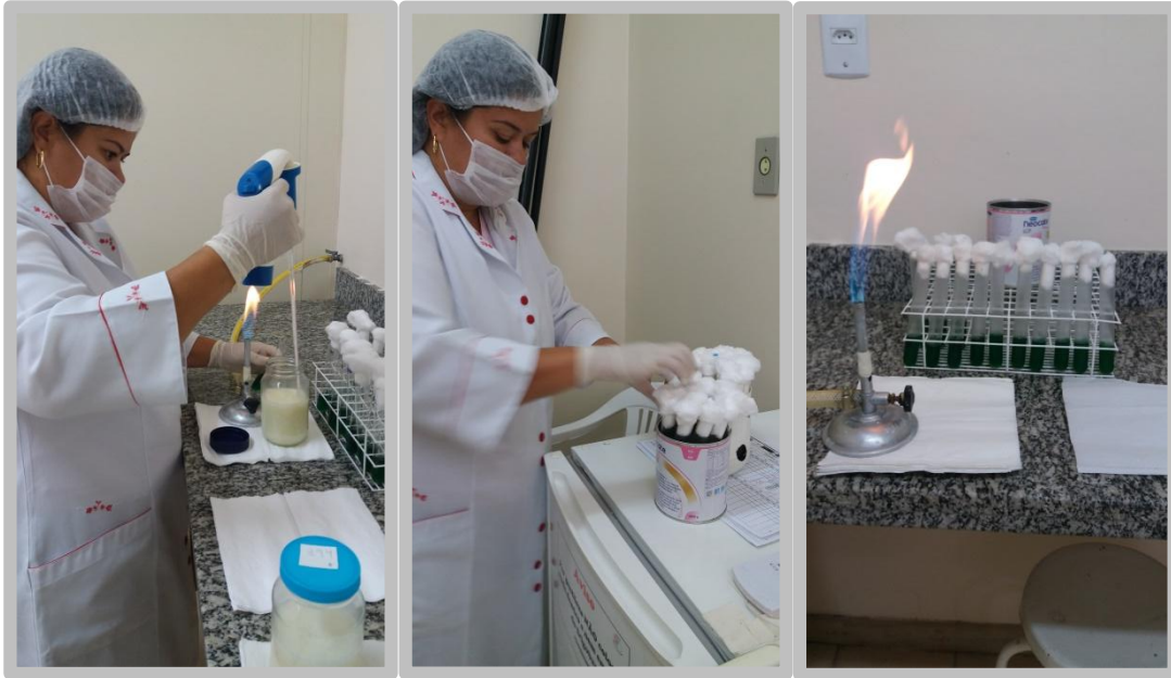
Figura 24-Medição Acidímetro de Dornic; Tubo de ensaio com o meio de cultura e tubo de Durham.
