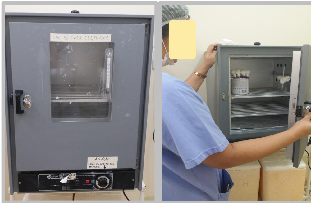
Figura 25-Estufa para cultura bacteriológica; Realização do processo de incubação do LHOC para investigação bacteriológica
