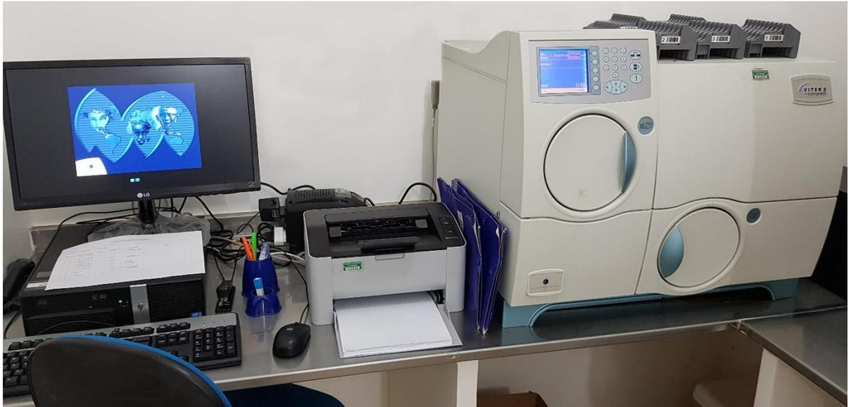
Os resultados são obtidos por meio de avaliações das atividades metabólicas desses microrganismos em interações com diversos substratos, sendo lido pelo método de turvação e colorimetria através de um sistema ótico utilizando três comprimentos de onda diferentes a cada 15 minutos e então comparados a um extenso banco de dados do VITEK<sup>®</sup>.
