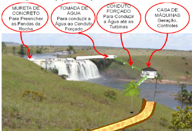
Figura 8: Prospecção do Arranjo da Minihidrelétrica da Andorinha
