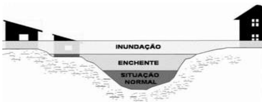
Figura 3 - Perfil esquemático do processo de enchente e inundação.
