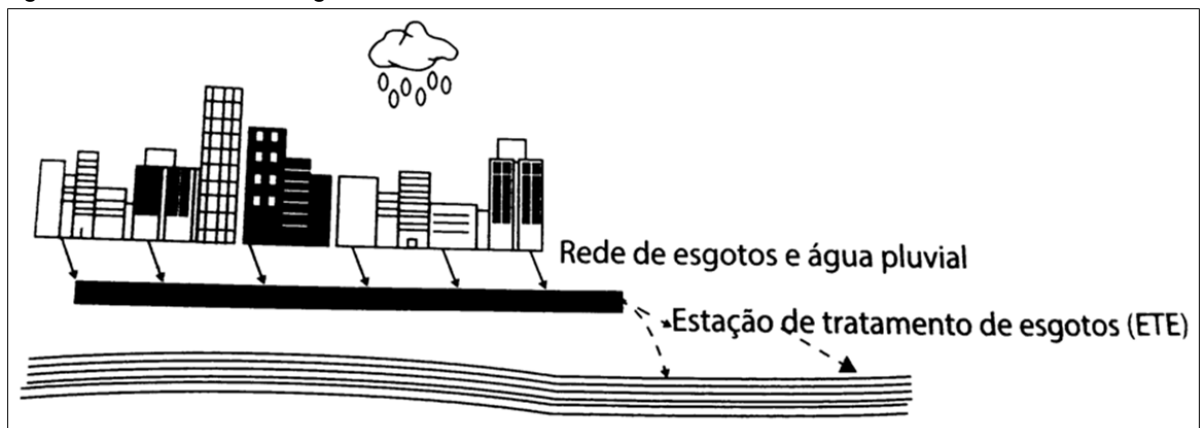
Figura 11 – Sistema de esgotamento combinado.
