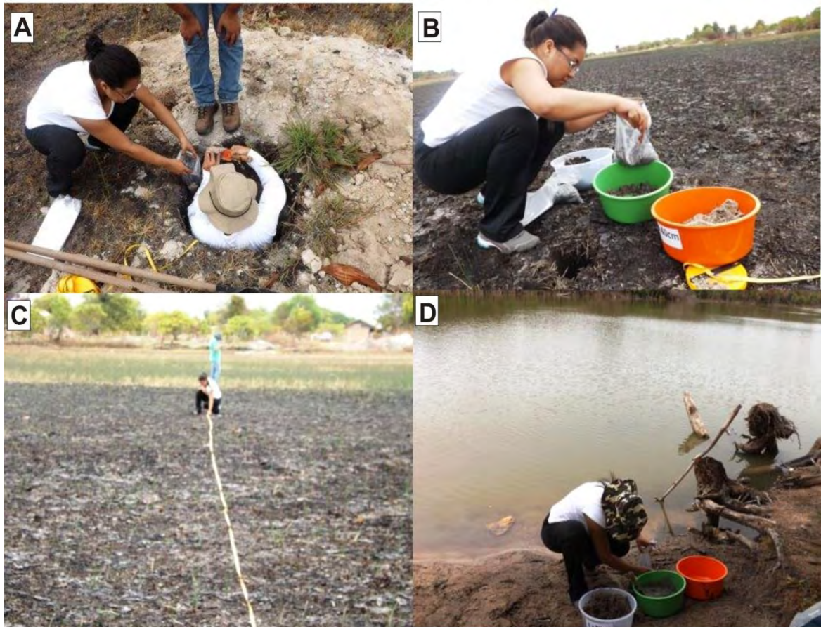
Figura 17: (A) Coleta dos sedimentos no Perfil (B e D) Armazenamento das amostras em saco plástico (C) Mensuração entre os pontos de coleta.
