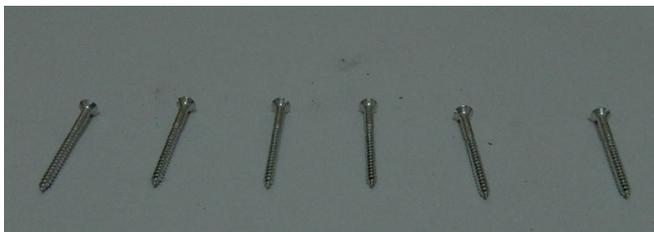
Figura 12 - Parafusos de sustentação das bases verticais
