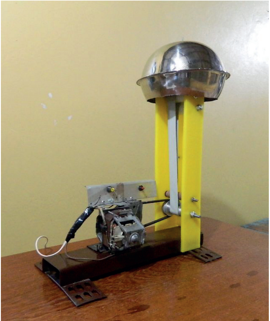
Figura 18. Gerador eletrostático feito com material alternativo e de baixo custo
