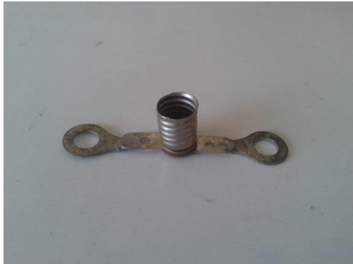
Figura 4. Soquete (receptáculo) com Terminal Olhal (Real)
