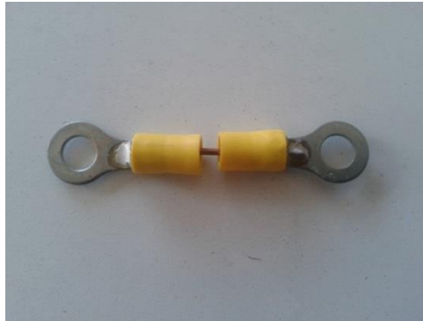
Figura 5. Conector Simples com Terminal Olhal (Real)
