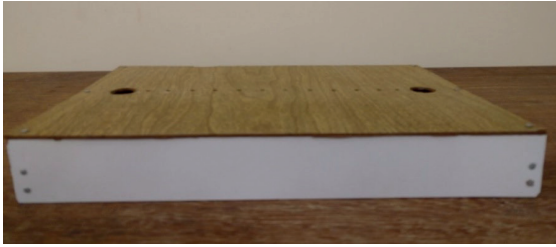
Figura 3: Base horizontal para sustentação do pêndulo. Fonte: A autora
